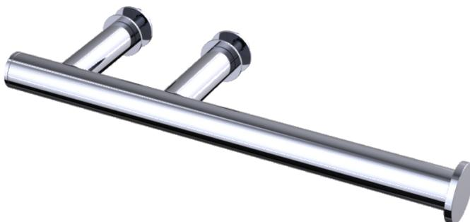
Distributeur papier rouleau simple Oméga en laiton chromé brillant. Tube Ø 16 mm. Pour volume de verre fixe. BTR inox de blocage. Fixation sur verre sécurit 8 mm | 10 mm. Ø de perçement du verre : 14 mm.
