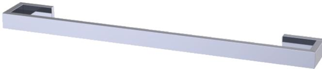
Porte-serviettes 1 branche 500 mm en laiton chromé brillant. Tube section carrée 25 mm, finition coupe onglet. Embouts de finition en laiton chromé. Visserie cachée. Platine de fixation en laiton injecté, 2 points d'ancrage avec trous oblongs de réglage. BTR inox de blocage. Visserie inox et chevilles fournies. Chromage garanti 5 ans.
