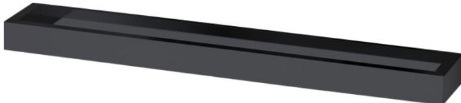
Porte-serviettes 1 branche 450 mm en laiton époxy noir. Finition coupe onglet. Embouts de finition en laiton époxy noir. Visserie cachée. Platine de fixation en laiton injecté, 2 points d'ancre avec trous oblongs de réglage. BTR inox de blocage. Visserie inox et chevilles fournies.
