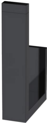
Porte-papier rouleau de réserve en laiton époxy noir. Finition coupe onglet. Embouts de finition en laiton époxy noir. Visserie cachée. Platine de fixation en laiton injecté, 2 points d'ancrage avec trous oblongs de réglage. BTR inox de blocage. Visserie inox et chevilles fournies.
