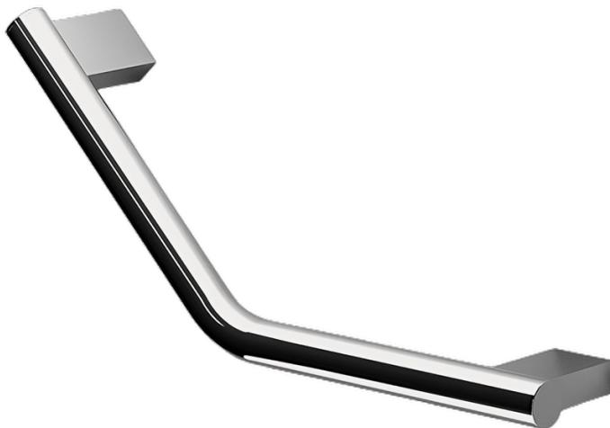
Barre de confort 135°, 370 x 370 mm, en laiton chromé brillant. Tube Ø 25 mm. Platine de fixation en inox 304L. 2 points d'ancrage par platine avec trous oblongs de réglage. BTR inox de blocage. Visserie cachée. Visserie inox et chevilles fournies. Chromage garanti 5 ans.
