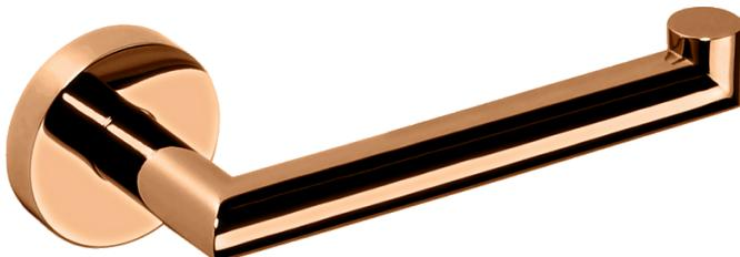
Distributeur papier rouleau simple en laiton, traitement PVD « cuivre ». Tube Ø 18 mm. Visserie cachée. 2/4 points d'ancrage avec trous oblongs de réglage. BTR inox de blocage. Embouts de finition en laiton. Visserie inox et chevilles fournies.
