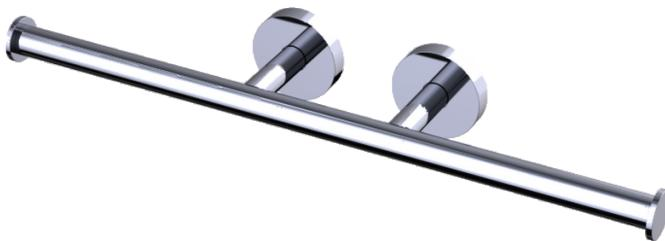
Distributeur rouleau double 2 rosaces en laiton chromé brillant. Tube Ø 16 mm. Embouts de finition et cache vis en laiton chromé. Visserie cachée. Platine de fixation en laiton injecté, 2/4 points d'ancrage avec trous oblongs de réglage. BTR inox de blocage. Visserie inox et chevilles fournies. Chromage garanti 5 ans.
