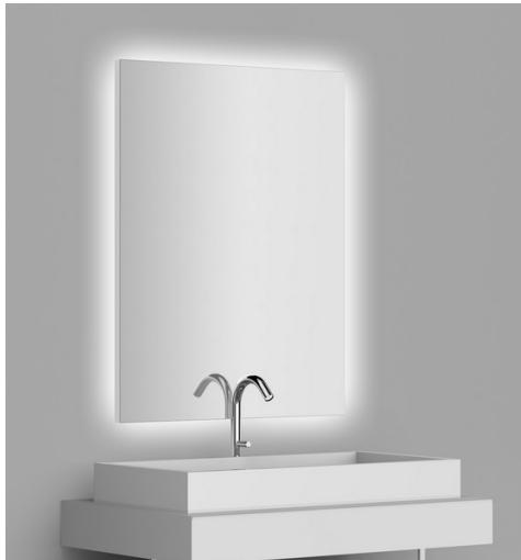
Miroir rétro éclairé Flex Led vertical éclairage inversé dimensions à définir. Film anti-buée 30 W. Driver isolation classe 2 volume 2 IP 44. Flex Led monochrome résiné 15 W/m NW 1120 lm/m IP 64. Durée de vie d'un Flex Led : 40 000 à 45 000 heures garanti 25 000 heures. Le Flex Led fonctionne en très basse tension de sécurité (TBTS). Température de couleurs : blanc chaud (2700°K). Puissance à déterminer selon la longueur du Flex Led. Livré monté prêt à la pose.
