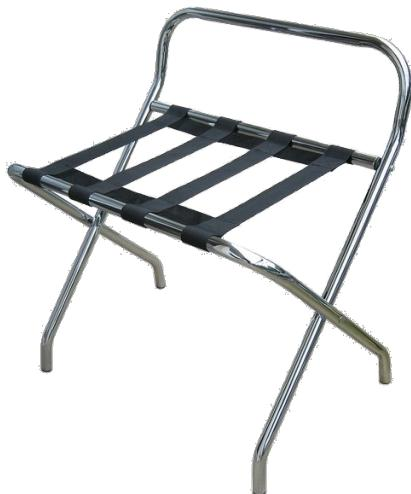
Rack porte valise métal avec dosseret chromé brillant. Tubes acier diamètre 25 mm. 4 sangles haute résistance + 2 sangles de maintien. Charge utile : 200 kg. Faible encombrement en position repliée.
