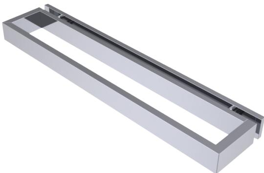
Poignée de douche extérieure 400 mm en laiton chromé brillant. Avec cache-vis. Tube section carrée 30 mm coupe onglet. BTR inox de blocage. Pour volume de verre fixe. Fixation sur verre sécurit 8 mm. Ø de perçement du verre : 13 mm.
