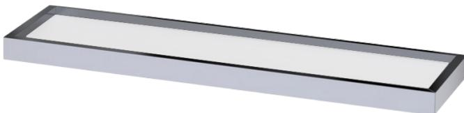
Porte-tablette 560 mm. Structure en laiton chromé brillant. Tablette en krion blanc. Finition coupe onglet. Embouts de finition en laiton chromé. Visserie cachée. Platine de fixation en laiton injecté, 2 points d'ancre avec trous oblongs de réglage. BTR inox de blocage. Visserie inox et chevilles fournies. Chromage garanti 5 ans.
