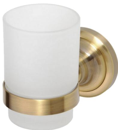
Porte-gobelet simple avec support mural en laiton bronze brossé. Gobelet en verre sécurit dépoli. Visserie cachée. 2 points d'ancrage avec BTR inox de blocage. Visserie inox et chevilles fournies.
