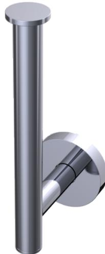
Porte-papier rouleau de réserve en laiton chromé brillant. Tube Ø 16 mm. Embouts de finition et cache vis en laiton chromé. Visserie cachée. Platine de fixation en laiton injecté, 2/4 points d'ancrage avec trous oblongs de réglage. BTR inox de blocage. Visserie inox et chevilles fournies. Chromage garanti 5 ans.
