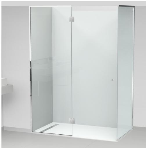
2 panneaux fixes en verre sécurit transparent 8 mm montés sur chacun sur 3 profilés en aluminium poli brillant 20 x 16 x 20 mm. Porte pivotante montée sur 2 charnières BALNEUM en inox 316 L brossé fixées sur le panneau fixe. Joints d'étanchéité en PVC translucide. Joint de seuil double lèvre avec lèche-goutte. Joint vertical côté charnières à bourrelet. Joint de fermeture à blocage. Visserie inox fournie.
