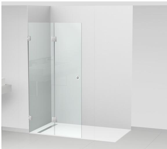
Façade 2 portes accordéon en verre sécurit transparent 8 mm montées sur 2 charnières mur/verre et 2 charnières verre/verre BALNEUM en inox 316 L brossé. Joints d'étanchéité en PVC translucide. Joint de seuil double lèvre avec lèche-goutte. Joint vertical côté charnières à bourrelet. Visserie inox fournie.
